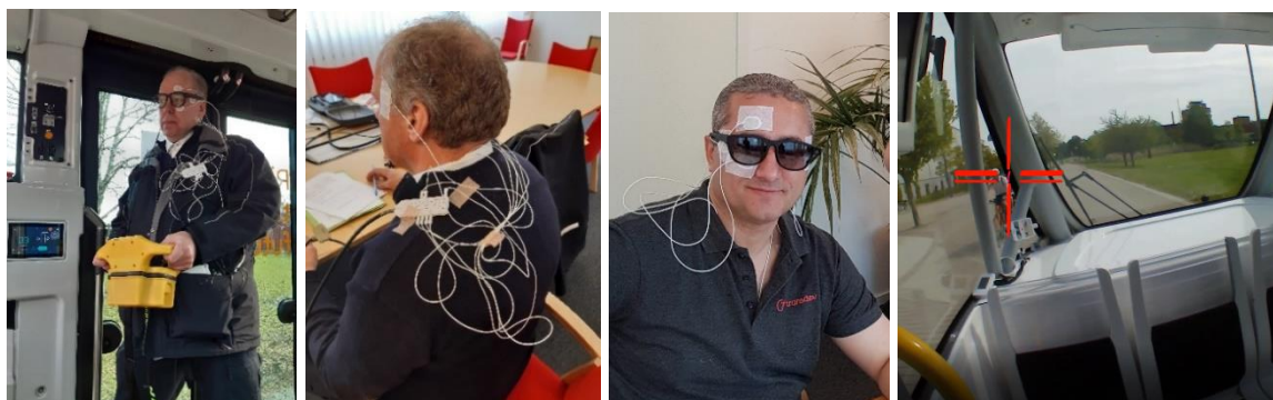
Figur 31 Kamerabaserat ögonrörelsesystem och elektrodapplicering.
