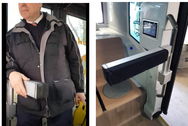
Figur 28 Säkerhetsarm för förarna. Går att falla in och ut. Tillverkad av Arne Johansson, VTI. Fotograf: My Weidel, VTI.
